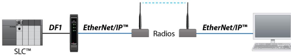
Erleichtert die Kommunikation zwischen einer DF1 und EtherNet/IP Steuerung innerhalb von großen Applikationen.
