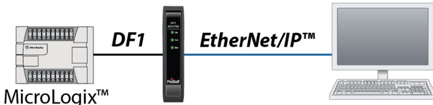
Upload und Download von einer DF1 Steuerung zu EtherNet/IP basierten Steuerungen
