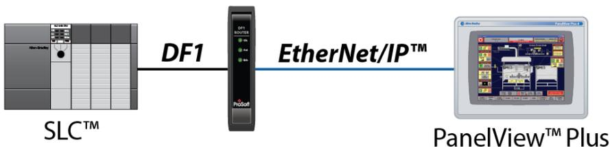
Ersetzen von älteren DF1 basierenden PanelView Terminals mit EtherNet/IP Terminals
