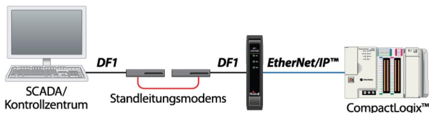
Verbindung einer Logix-basierenden Steuerung zu PCs über das DF1 Radio Modem
