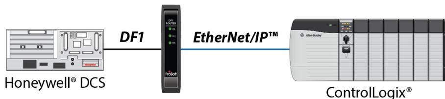
Verbindung einer Logix-basierenden Steuerung zu einem Honeywell DCS System
