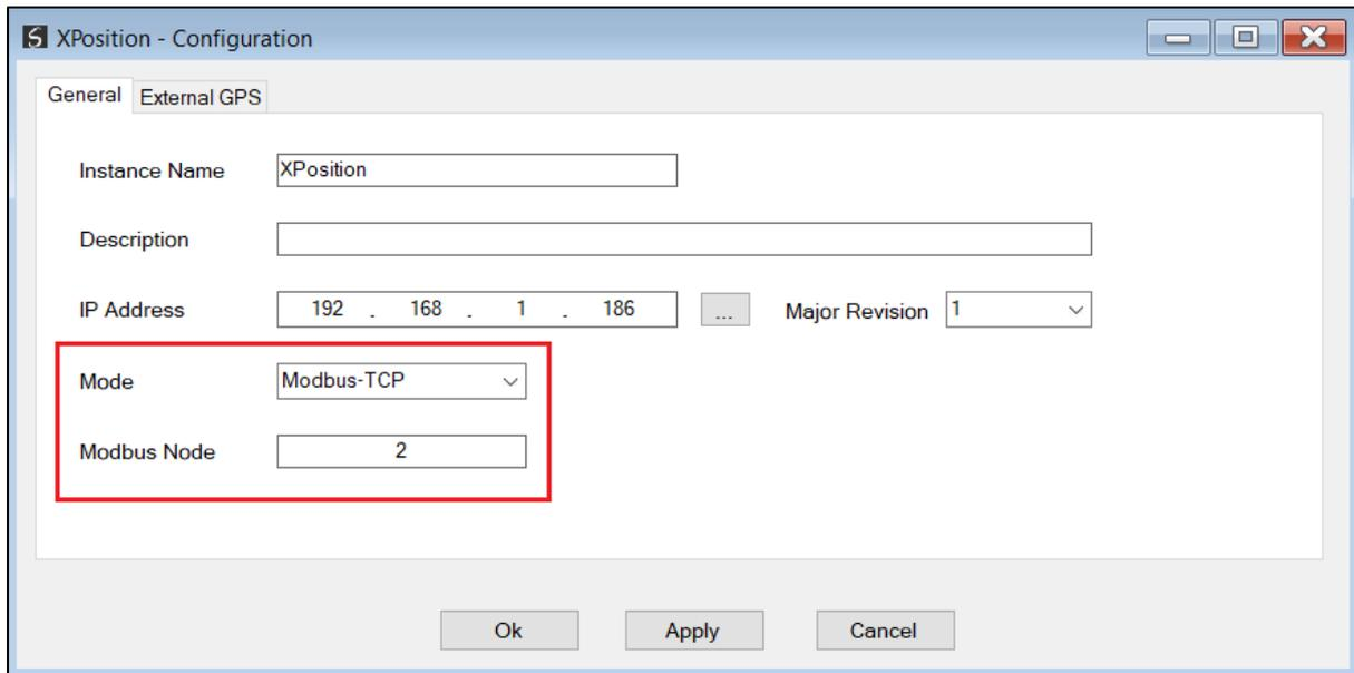
Figure 3.31. – Modbus TCP mode
