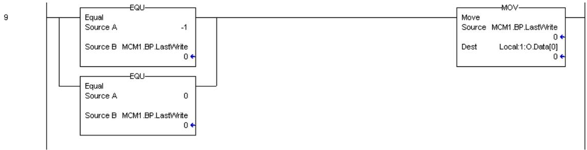
El siguiente rung en la lógica de escalera es el más importante. Maneja la transferencia de datos del procesador hacia el módulo. Hasta 200 palabras de datos del usuario son mantenidas en el procesador (**MCM.WriteData[]**) pueden ser transferidas al módulo cada vez.
