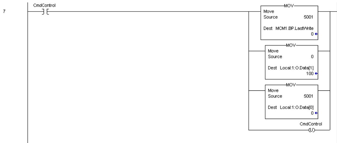
Cuando el bit CmdControl es ajustado, el puerto comando Maestro 1 (indice 0) será colocado en la cola comando y ejecutado. Hasta 6 comandos pueden ser transferidos con una solicitud desde la lista de comandos hasta la cola de comandos.
