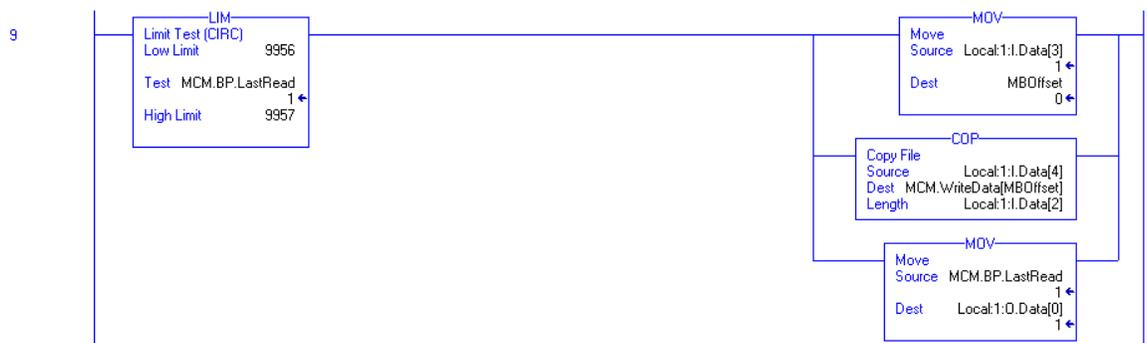
Este rung es usado para manejar código de función 5 requerido cuando el módulo está siendo utilizado como un Esclavo en el modo Pass-Through formateado:
