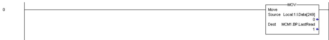
Si el módulo está configurado para los bloques cero o uno, enviará bloques con código de identificación de 0 y -1. Ninguno de los datos del usuario será incluido en éstos bloques. Ellos sólo contendrán el estado de los datos. El rung presentado abajo muestra la lógica que maneja esos bloques.
