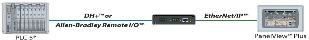
Dieser Modus ermöglicht es, bestehende PanelViews auf Remote I/O- oder DH+-Basis auf einen PanelView Plus, PanelView Plus 6 oder PanelView Plus 7 auf EtherNet/IP-Basis hochzurüsten.
