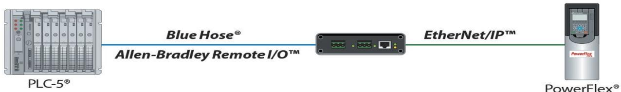
Dieser Modus unterstützt das Hochrüsten von bestehenden Allen Bradley Remote I/O-Drives auf neue EtherNet/IP-fähige Drives.
