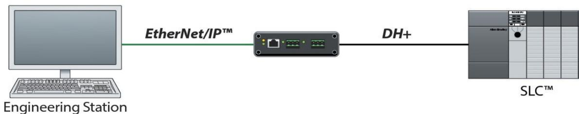
Dieser Modus arbeitet als Brücke zwischen einem EtherNet/IP- und einem Data Highway Plus-Netzwerk.
