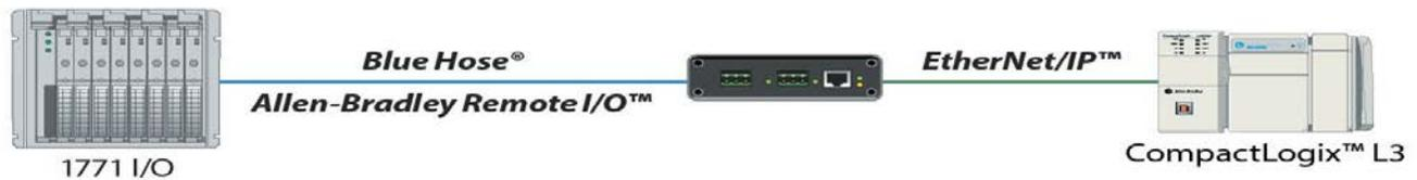
Dieser Modus ermöglicht es Benutzern, ihre bestehende Remote I/O SPS gegen eine ControlLogix oder CompactLogix-PAC auszutauschen, ohne bestehende E/A-Racks austauschen zu müssen.
