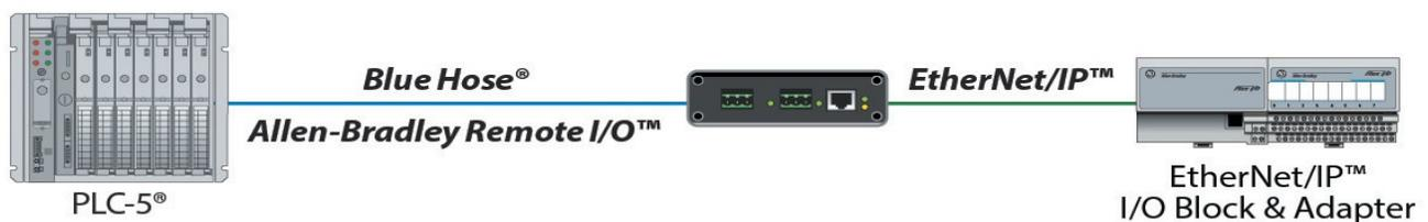
Dieser Modus ermöglicht es SPS in einem Remote I/O-Netzwerk, eine Verbindung zu 1794-AENT EtherNet/IP Flex-Adaptoren herzustellen und diese zu steuern.
